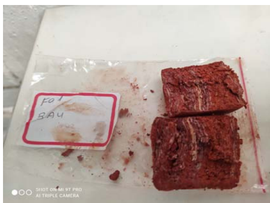
Fotos 06 a 09 – No alto, da esquerda para a direita = a) b) c) e d) solos residuais de rochas do Embasamento Cristalino, argilo siltosas a silto argilosas, com laminações e lentes de quartzo grosseiro. Foto do autor.
