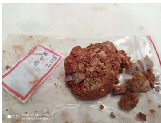
Fotos 06 a 09 – No alto, da esquerda para a direita = a) b) c) e d) solos residuais de rochas do Embasamento Cristalino, argilo siltosas a silto argilosas, com laminações e lentes de quartzo grosseiro. Foto do autor.
