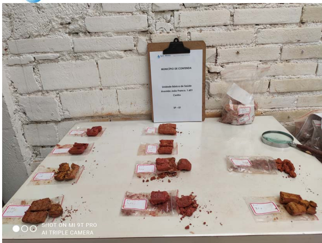
Foto 05 – Amostras do furo SP-01 dispostas para descrição. O topo se encontra no canto inferior esquerdo e a base, no canto superior direito. Foto do autor.
