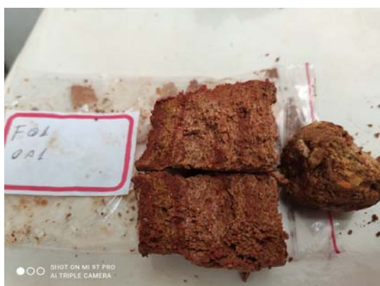
Foto 05 – Amostras do furo SP-01 dispostas para descrição. O topo se encontra no canto inferior esquerdo e a base, no canto superior direito. Foto do autor.
