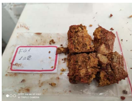
Foto 05 – Amostras do furo SP-01 dispostas para descrição. O topo se encontra no canto inferior esquerdo e a base, no canto superior direito. Foto do autor.
