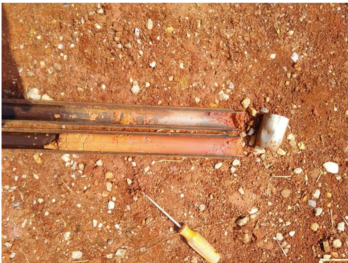
Foto 04 – Amostrador aberto expondo a recuperação da coluna de solo do furo SP-01. Foto Sergio
